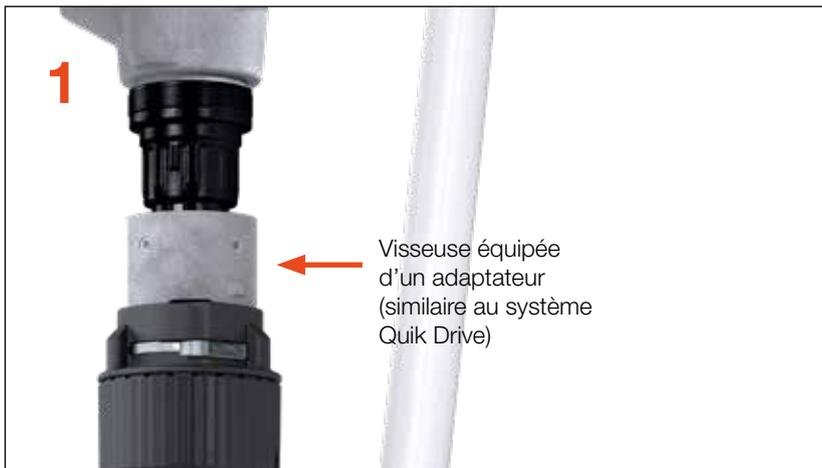
Monter la visseuse équipée d'un adaptateur, sur l'outil Timber Drive (compatibilité visseuse et adaptateur similaire au système Quik Drive®, information disponible sur simpson.fr)
