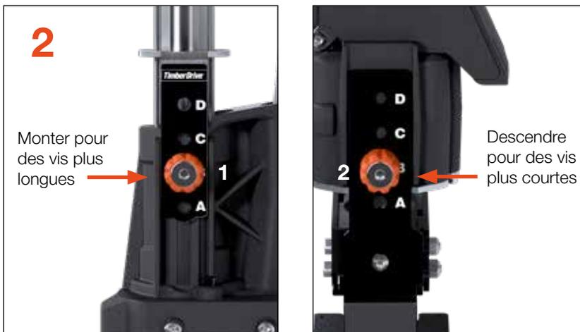
Régler l'outil en plaçant la vis de réglage 1 et 2 sur la lettre correspondante, fonction de la longueur de vis.
